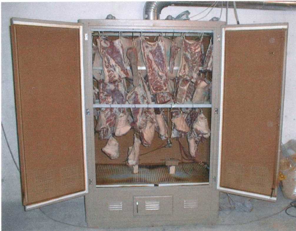
Abb. 3: ... zeigt den gefüllten Räucherschrank und einige Temperaturfühler
