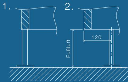
1. Höhenverstellbarer Edelstahlfuß mit trittsicherer Boden-rossette, Oberfläche gebürstet
