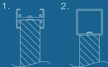
1. Aluminium Deckprofil einfassend in Farbe der Trennwand
