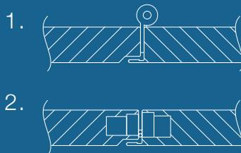
1. Edelstahl-Federbänder eingefälzt, selbst-schließend, Oberfläche gebürstet
